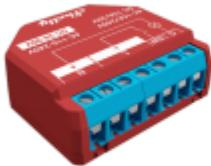
Il Shelly Plus 1PM è un dispositivo di automazione domestica progettato per controllare e monitorare i carichi elettrici. Ecco alcune sue caratteristiche:
