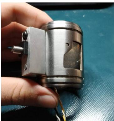
Il blocco della pulsantiera verrà attaccato attraverso una vite a questa sezione di tubo che servirà per coprire la camera del cristallo.
